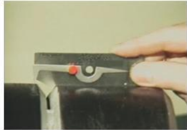
Desalineamiento de la junta
