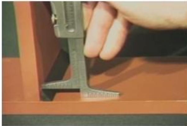
Longitud de pierna en soldaduras de filete
