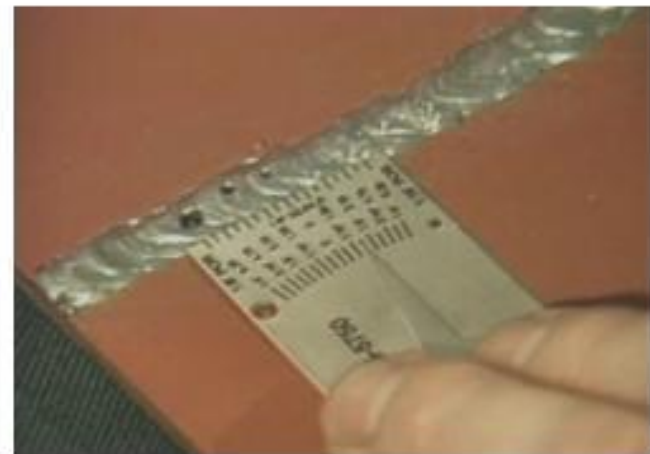
Cantidad de poros por pulgadas y diámetro
