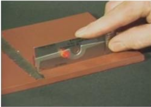
Profundidad de socavados o picaduras
