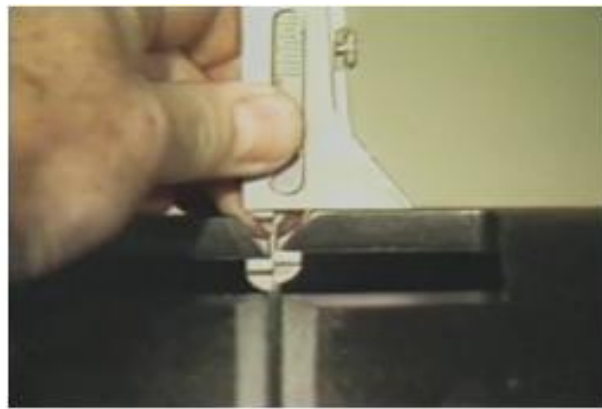
Desalineamiento (Hi-Lo) durante el ajuste
